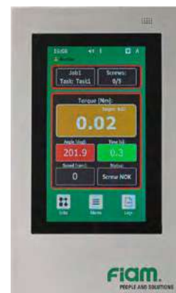
Visualizzazione degli esiti di avvitatura: tavola di riferimento Viewing of tightening results: reference table
